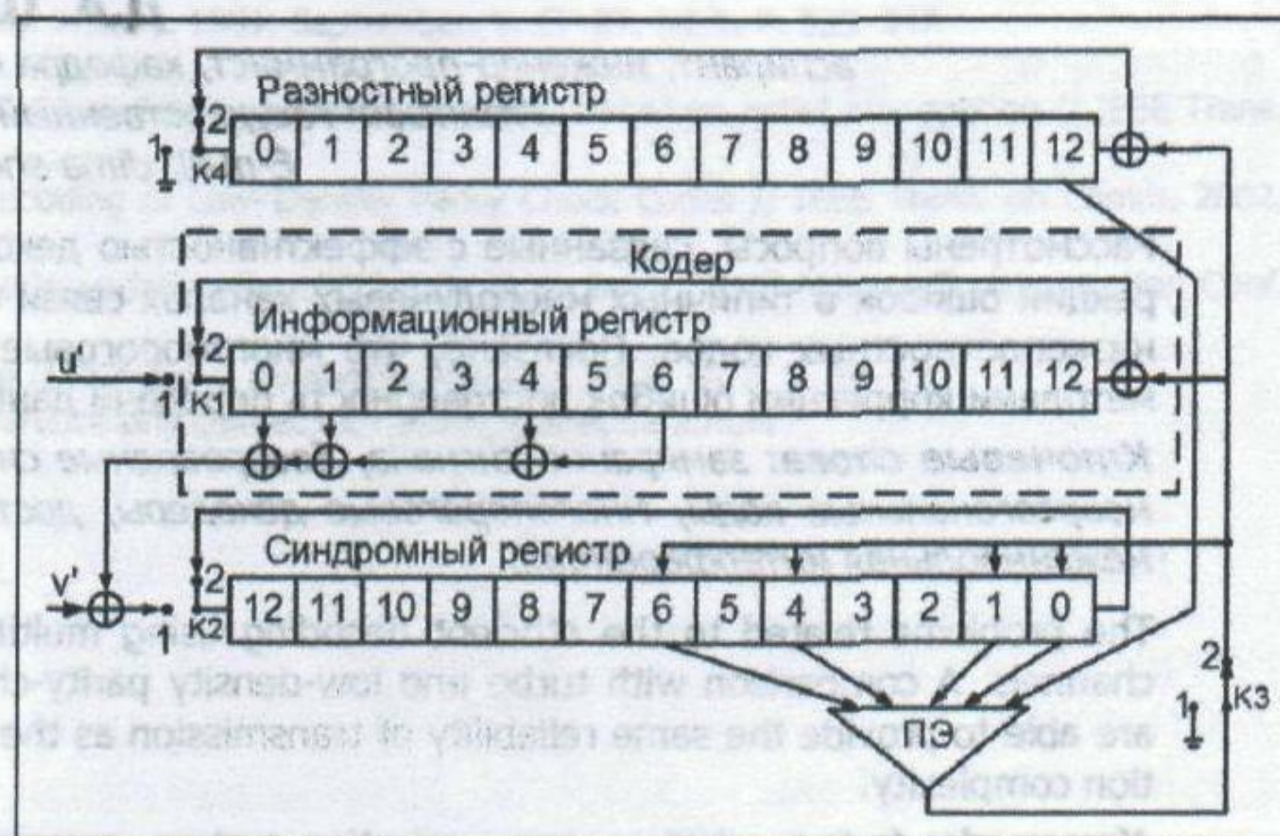
Рис. 2. Схема декодера МПД блочного кода
