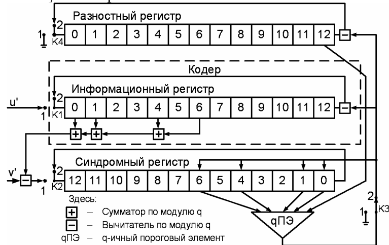
Рис. 9. q МПД блочного СОК с R=1/2 , d=5 и n=26 . Верхние входы ячеек 0, 1, 4 и 6 регистра синдрома вычитаются по модулю q из содержимого соответствующих ячеек
